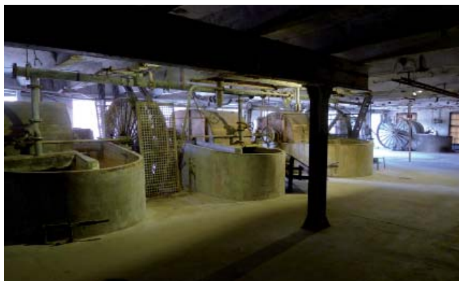
Holländeriet med åtta holländare för malning, blandning och färgning av massan. Foto Eric Julihn 2013.
