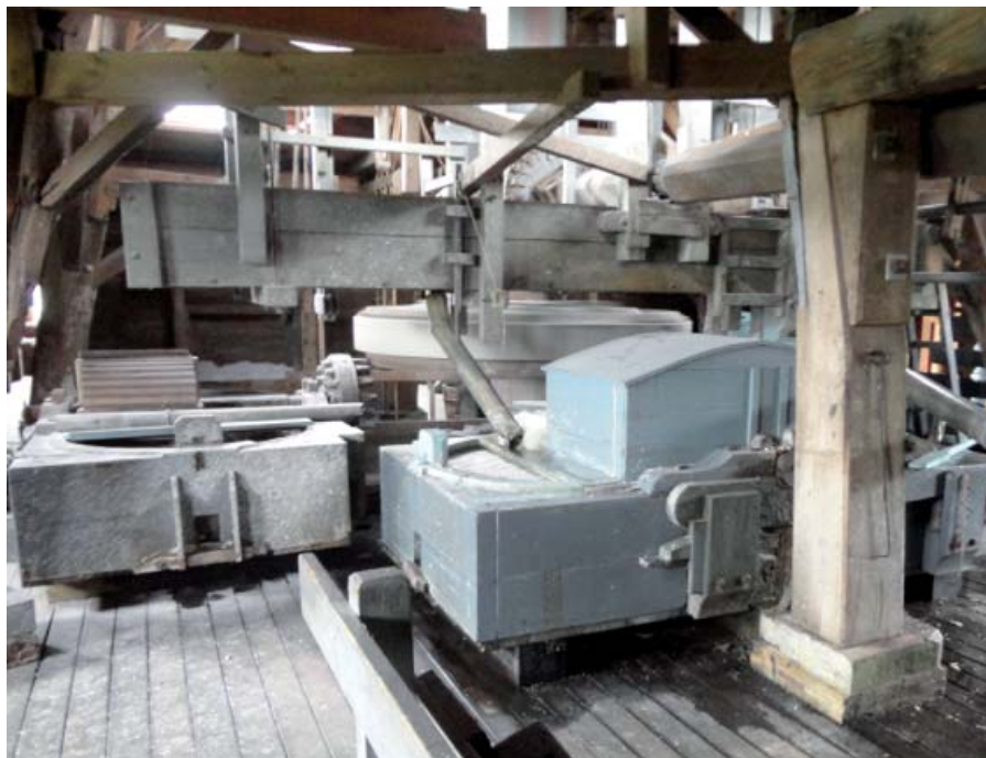
2. 2 af møllens hollændere. I midten af billedet ses møllens hovedaksel (Foto: Dorte Sommer)
