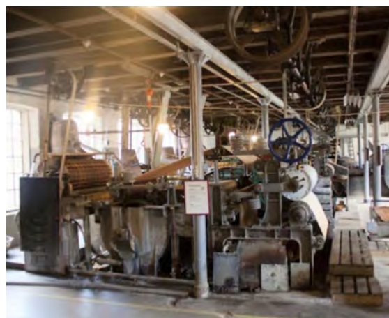
Fungerende rundviremaskine på Bruunshåb Papfabrik
