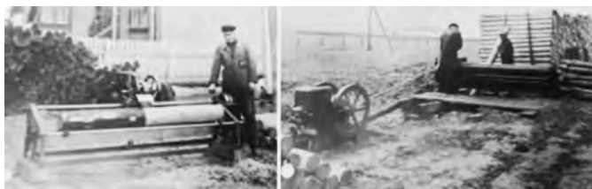
Bild av en barkningsmaskin, troligen av den typ som fanns i Kannuskoski.
