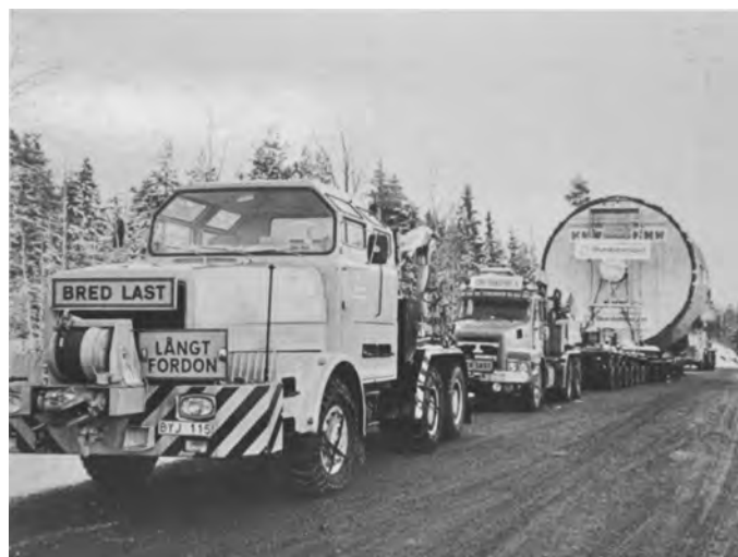
Världens största yankeecylinder, 6,4 meter i diameter och 7,2 meter bred, fraktades med båt från Karlstad, runt södra Sverige och in i Mälaren till Köpings djuphamn och därefter till Frövifors på landsväg i ett långt ekipage med upp till fyra dragbilar.
