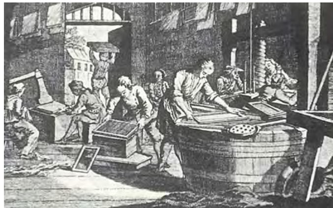
Handpapperstillverkning i Europa på en etsning från 1762. I förgrunden sker formning, i mitten guskning och i bakgrunden till höger pressning med en stor skruppress av trä med tre arbetare som drar pressen. Bilden från "Papermaking through eighteen centuries".
