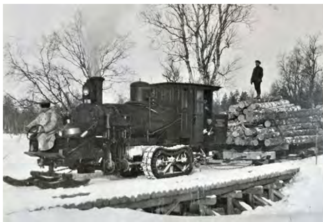
Ett skogslokomotiv för virkestransport från 1913. (Bild från Jaakko Auer (1).)
