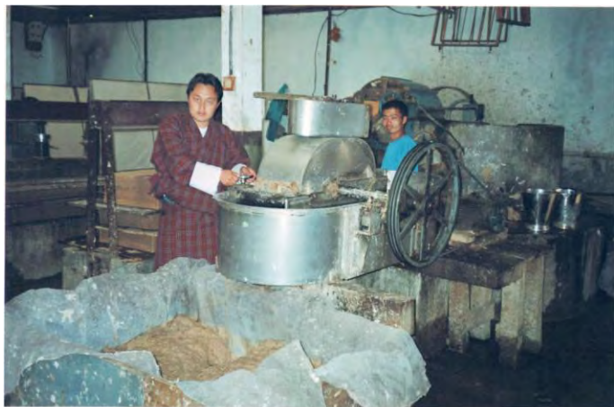
Vid ett besök hos en handpapperstillverkare i Thimphu, Bhutan, användes denna lilla holländare för malning av massan.
