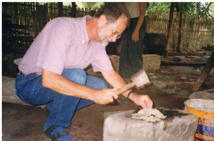
Författaren praktiserar "beating" och bearbetar fibrerna med en träklubba, en manuell variant av de vattenhjuldrivna stampar som användes i svenska handpappersbruk före holländarens inträde på 1700-talet. Bilden från besök i Luang Prabang, Laos.
