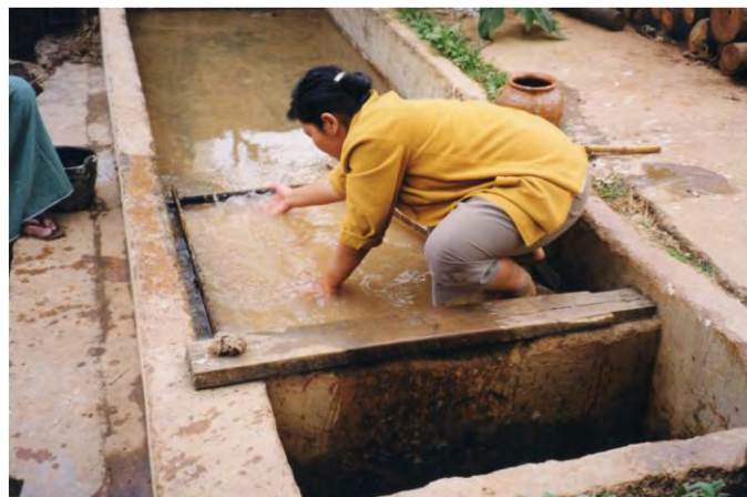
Massan rörs om manuellt före arkformning. Bilden från besök i Myanmar.
