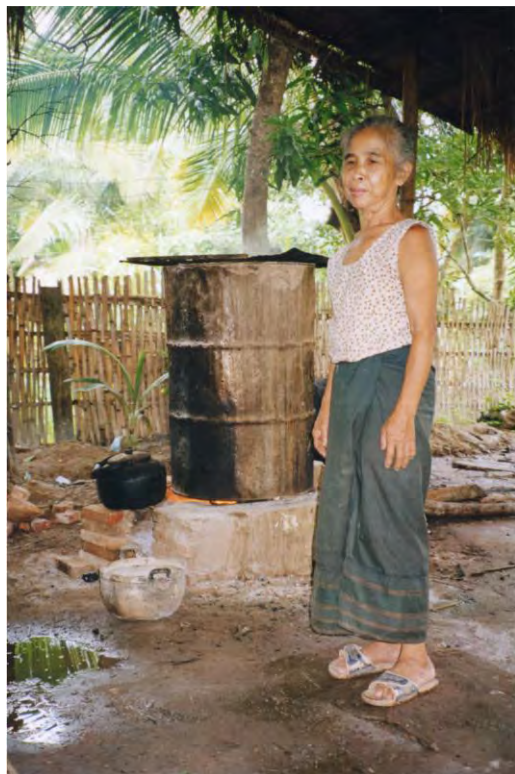
Enkel teknik för att framställa pappersmassa från mullbärsbuskebark.
