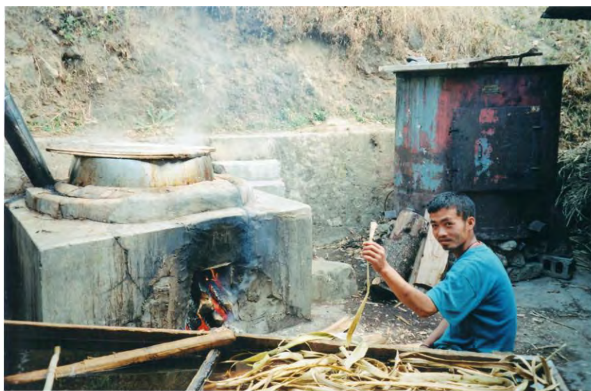
Enkel teknik för att framställa pappersmassa från mullbärsbuskebark.
