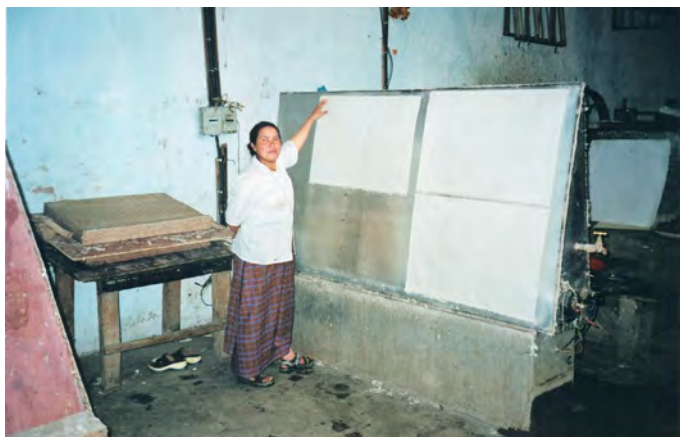
Torkning av de våta arken mot en uppvärmd plåtpanel i Timphu, Bhutan. Metoden torde ge en slät yta på ena sidan av arket, påminnande om ett MG-papper.
