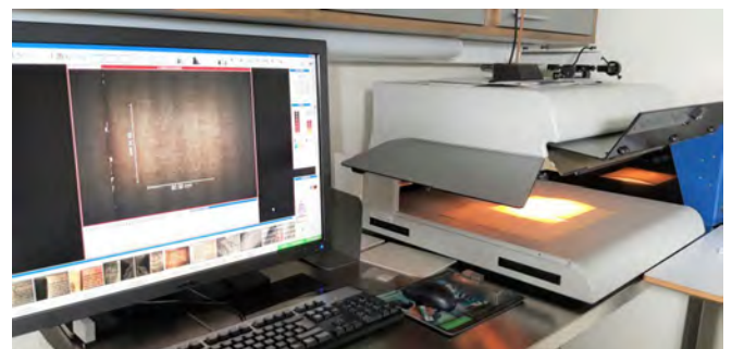
Fig 17. Multispektralanalyse Video Spectral Comparator (VSC 6000©) er et instrument utstyrt med omfattende software. Dokumentet blir plassert inni instrumentet (til høyre), og det operative administreres og anleses via skjermen. (Foto: Nasjonalbiblioteket)
