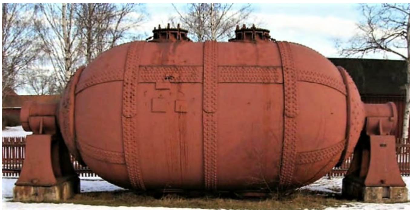
Liggande roterande sulfittmassakokare levererad 1889 av KMW till Turbo sulfittmassafabrik. Kokarvolymen är 25 m 3 . Kokaren finns idag uppställd utanför Gruvmuseum i Falun (Foto Gruvmuseum Falun)
