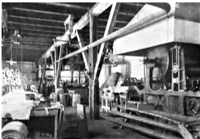
Pergamenteringsmaskinen vid Kangas pappersbruk. Genom att behandla ett poröst papper med svavelsyra erhöles vegetabiliskt pergament, ett mycket tätt papper för t.ex. smörförpackning
