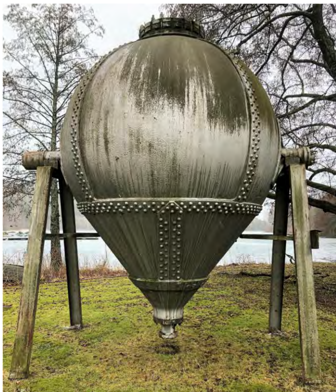
Sfärisk massakokare från Gustavsfors massafabrik, numera uppställd vid Billingsfors Bruk.
