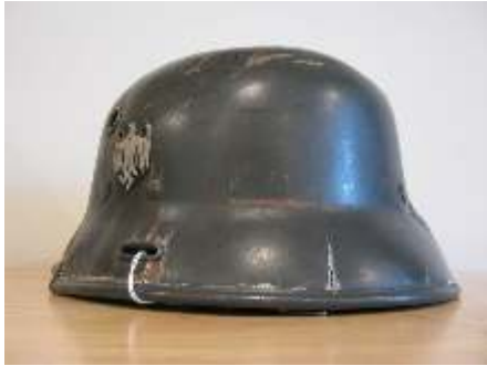
Tysk soldathjälm tillverkad av vulkanfiber. Den kallades Model 3 Vulkanfiber prototyp-hjälm och utvärderades men underkändes av tyska Wehrmacht 1932. Den ansågs ge för dåligt skydd mot beskjutning.
