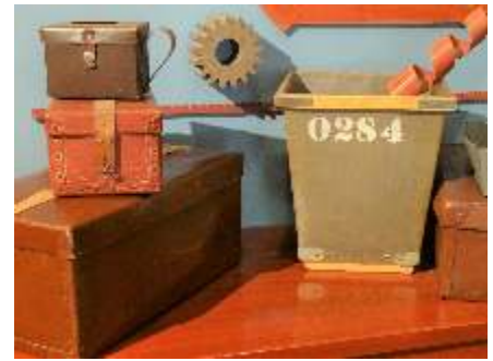
Produkter tillverkade av vulkanfiber från AB Tidán. Boxar av olika slag, den gröna för militära ändamål, kugghjul och kubbstång, samt någon typ av spialfjäder. Vadsbo museum, Mariestad. Foto Dagjoh (Own work)
